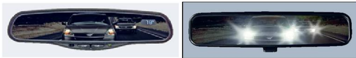
لایه های الکتروکرومیک در آینه عقب خودرو
