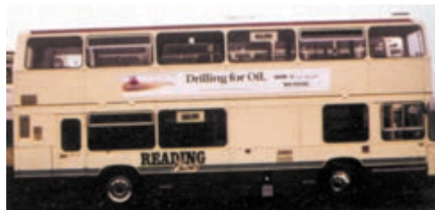
این اتوبوس به طور آزمایشی با زیست دیزل تولیدی از روغن گیاه شَرشَم به راه افتاده است.
