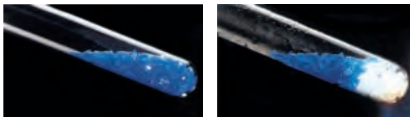
الف) تبدیل مس (II) سولفات پنج آب به مس (II) سولفات خشک
