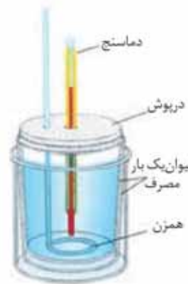
شکل ۸- ساختار گرماسنج لیوانی
