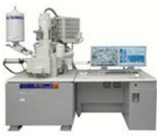
شکل (۱-۲). نمونه‌ای از دستگاه SEM
