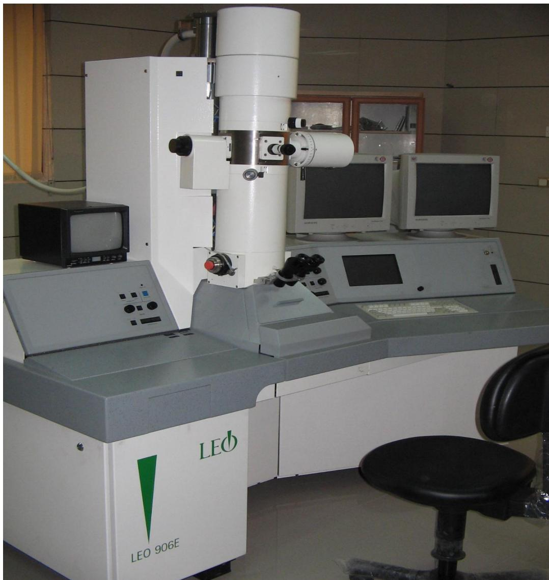
اصول ساختمان این میکروسکوپ مشابه میکروسکوپ نوری است. اما پرتو‌های مورد استفاده به جای فوتون‌ها، از الکترون‌ها که طول موج‌شان در حد آنگستروم است تشکیل شده‌اند. تولید الکtron از طریق گرم نمودن فیلامان تنگ‌ستن صورت می‌گیرد. این الکترون‌ها بوسیله اختلاف پتانسیلی تا ۱۲۰ کیلو ولت شتاب می‌گیرند. دسته پرتو
