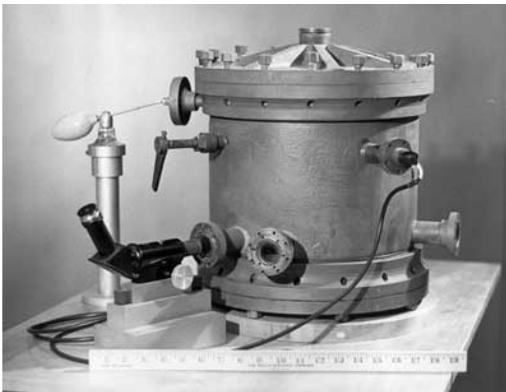
توضیح شکل: دستگاه استفاده شده در آزمایش قطره روغن میلیکان (منبع: Wikipedia)
