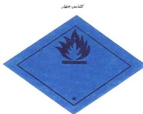
برچسب کلاس ۴-۲ با توجه به خصوصیت کالا بخای ستاره شماره کلاس مربوطه درج می شود. مشخصات: موادی که در واکنش با آب گازهای قابل اشتعال متصاعد می کنند. رنگ زمینه : آبی نماد: شعله آتش به رنگ سیاه یا سفید
