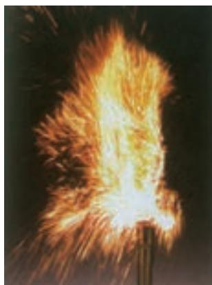
شکل ۱۰- سوختن گردآهن. اغلب فلزها مانند آهن در شرایط مناسب با گاز اکسیژن می‌سوzenد.
