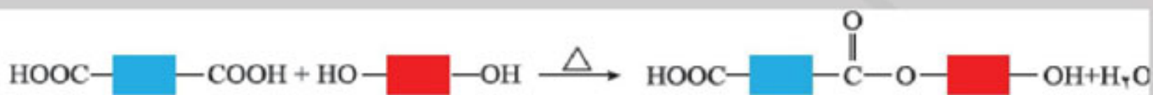
شکل ۱۵ - الگویی از واکنش استری شدن بین یک کربوکسیلیک اسید و الکل دو عاملی
