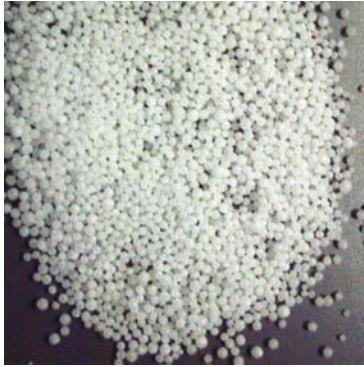
بوریا را در صنعت از ترکیب امونیا ( $\text{NH}_3$ ) و کاربن دای اکساید ( $\text{CO}_2$ ) به فشار بلند در دو مرحله به دست می‌آورند. ابتدا امونیم کاربامیت تشکیل می‌شود:
