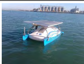
استفاده از انرژی خورشیدی و باتری به عنوان منبع انرژی در قایق ربات خودران به منظور کنترل، حفاظت و پایش عمق پای اسکله ها و حوضچه های بنادر، طراحی شده در دانشگاه تهران
