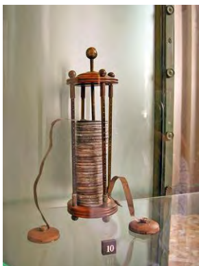
آلساندرو ولتا، پیل ولتا را ابداع نمود. پیل ولتا از صفحات گرد، مس و روی تشکیل شده است که به طور متناوب روی هم قرار گرفته است که بین آنها صفحات کاغذی آغشته به نمک وجود دارد.
