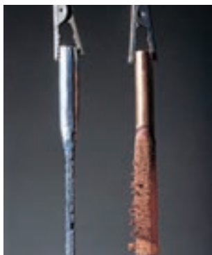
● شکل ۸- تغییر جرم تیغه‌ها پس از کار کردن در سلول گالوانی روی - مس.
