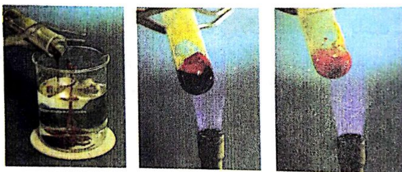
شکل ۴-۱۴ اثر گرما بر گوگرد و تهیه گوگرد کشسان (گوگرد بی‌شکل) الف - گوگرد را گرما می‌دهند تا به مایعی روان به رنگ زرد نارنجی تبدیل شود. ب - با گرم کردن بیشتر به مایع قهوه‌ای رنگ و چسبنده تبدیل می‌شود. پ - با سرد کردن ناگهانی مایع یک جسم کشسان پدید می‌آید که شبیه به لاستیک است.
