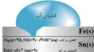
به آهنه که سطح آن با لایه نازکی از فلز قلع پوشیده شده است، حلبی می‌گویند. که از آن برای ساختن قوطی‌های کسره و روغن نباتی استفاده می‌کنند. هر گاه در سطح حلبی خراش ایجاد شود، در محل خراش یک سلول گالوانی در محل خراش یک سلول گالوانی تشکیل می‌شود. در این سلول Fe به عنوان آند اکسایش یافته، خوردگی می‌شود.
